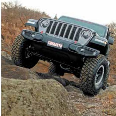
ボディにヒットせずに足回りが自在に動くだけでなく、テスト車両のV6(3.6L)とローレシオのサブトランスファーにより、低速トルクを利用したジワジワと走るクローリングを実現。しなやかだがしっかり抑えの効いたサスペンションは、林道などのダートランにおいても快適なもの。
