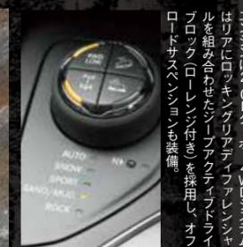
エンジンは2.0Lターボ、4WDシステムはリアにロックアップリアアクティブディファレンシャルを組み合わせたジープアクティブドライブIIロックローレンジ付きを採用し、オフロードサスペンションも装備。
