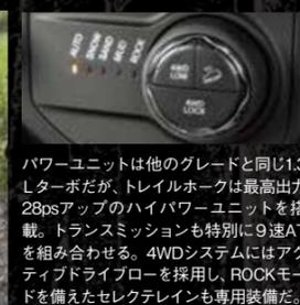
パワーユニットは他のグレードと同じ1.3Lターボだが、トレイルホークは最高出力28psアップのハイパワーユニットを搭載。トランスミッションも特別に9速ATを組み合わせる。4WDシステムにはアクティブドライブIIを採用し、ROCKモードを備えたセレクトトレインも専用装備だ。
