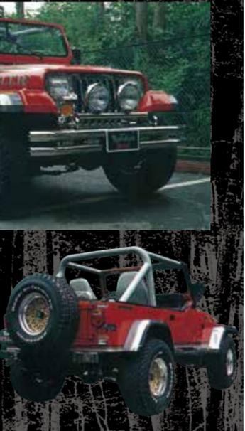
カスタム バックセジ「ラングラー タイガーパッケージ」。マイルドなリフトアップにツインチューブのクロームバンパー&ランプ。外径アップ&ワイド化を行なったオフロードタイヤ、合わせて装着されたワイドオーバーフェンダーなど、当時一世を風靡したスタイルを持つ。
