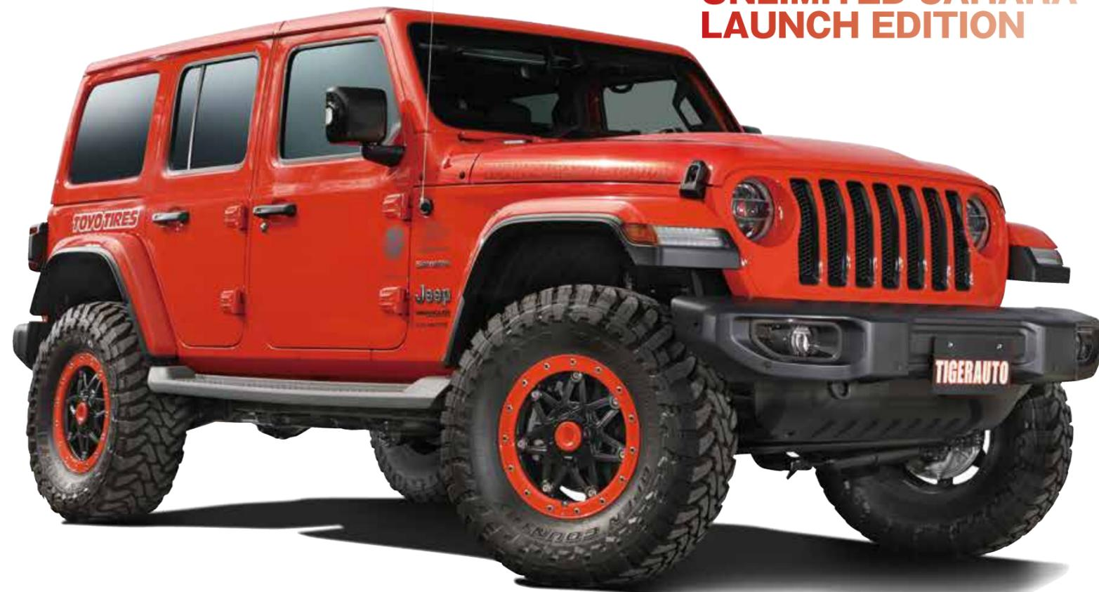
2インチアップコイルスプリング (MOPAR製) でリフトアップ。ノーマルとの差別化を図るために各所にMOPER製パーツを積極的に取り入れている。ボディカラーと同系色のMG LYCAN (17×7.0J+38)ホイールを合わせることで、スタイリッシュなエクステリアを実現した。リアスペースにオリジナルのドリンクホルダーを追加している。
