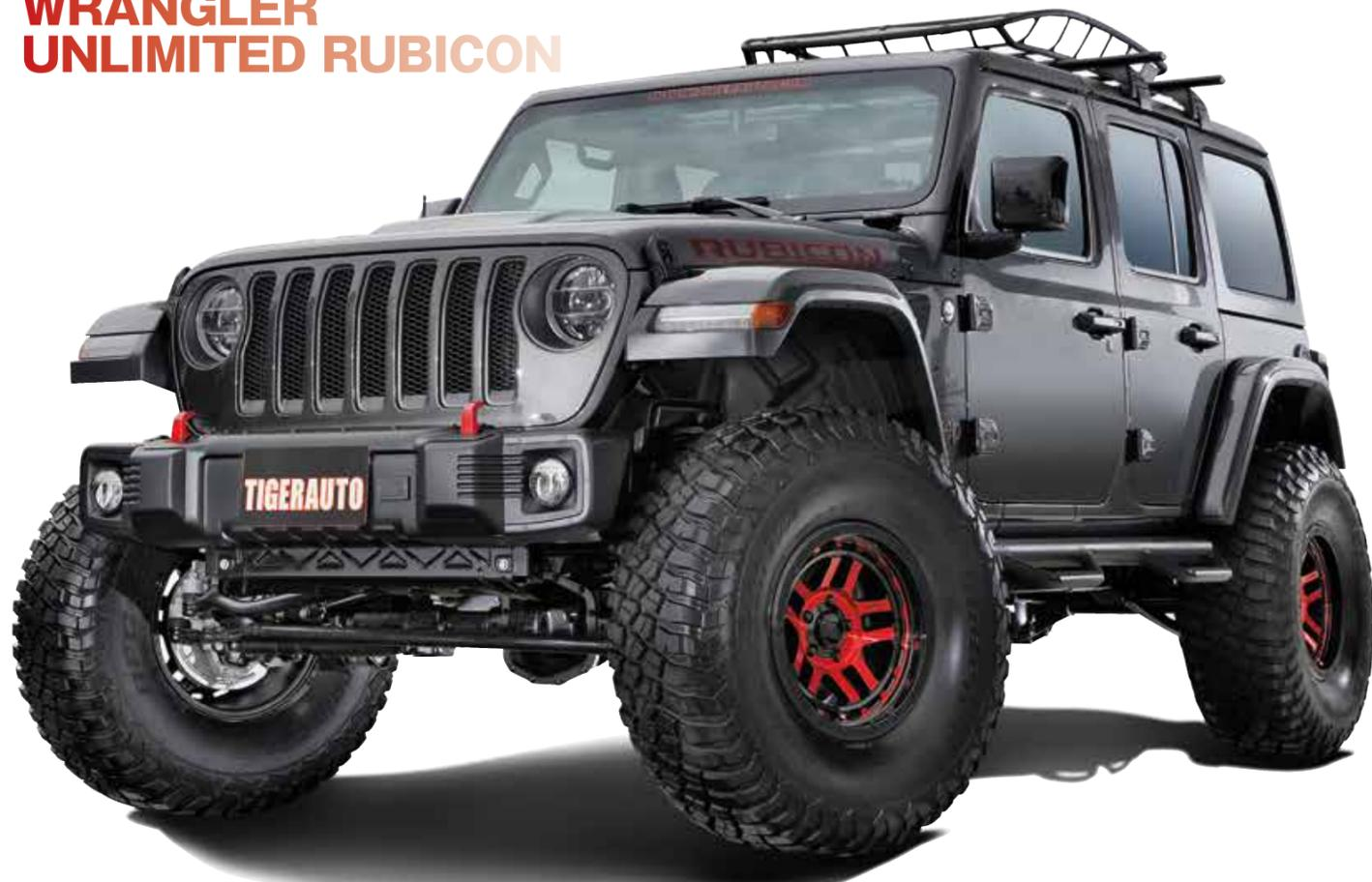
オートサロン2019で披露された3.5インチアップのJL型ルビコン。このモデルは、タイガーオートがカスタムの指針としているRUBICON EXPRESSのパーツが多用されている。この製作により、多くのノウハウを得ると同時に、新たなカスタムパーツの開発のヒントも得ている。タイヤは39インチのBFGoodrich KM3を履く。
